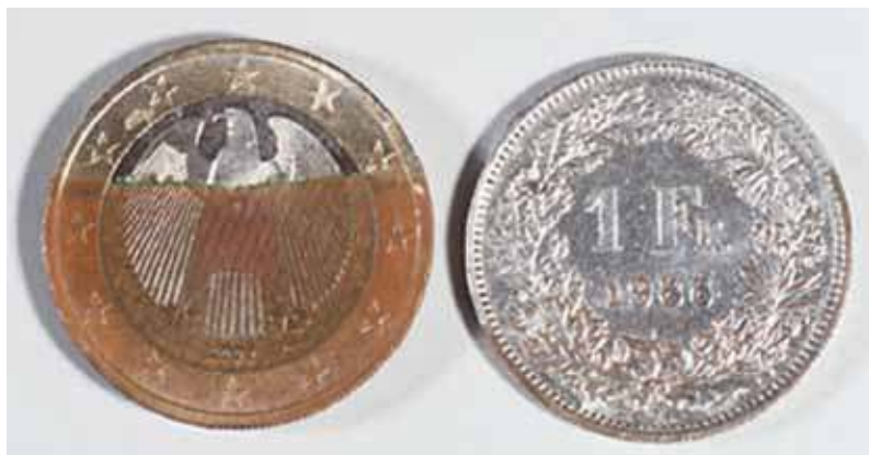
3. ábra: A 36 órán keresztül 2/3 magasságig mesterséges verejtékbe merített 1 eurós (balra) érme korrodálódik és nikkelt ad le. A hasonló nikkeltartalmú 1 svájci frankos pénzérme (jobbra) nem változik. (Zürichi Egyetem, Bőrgyógyászati Klinika fotója)
