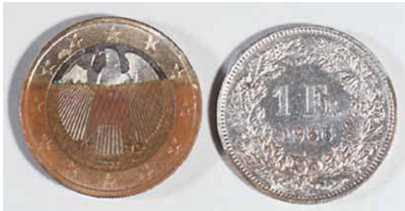
3. ábra: A 36 órán keresztül 2/3 magasságig mesterséges verejtékbe merített 1 eurós (balra) érme korrodálódik és nikkelt ad le. A hasonló nikkeltartalmú 1 svájci frankos pénzérmé (jobbra) nem változik. (Zürichi Egyetem, Bőrgyógyászati Klinika fotója)
