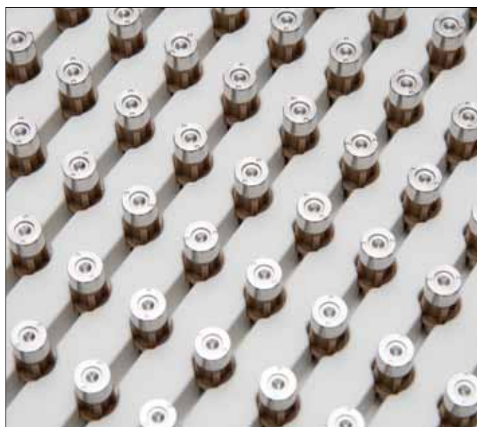
6. kép: Kész Respimat® fuvókák közelről
